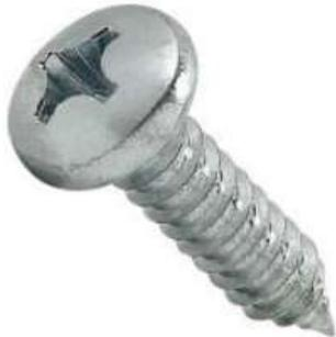
O [parafuso auto atarraxante](#) possui uma rosca mais fina e cortante que o faz “agarrar” com mais força no furo. Dependendo do caso, não necessita de um furo prévio, já que com sua dureza maior, consegue resistir ao esforço de abrir a rosca.
